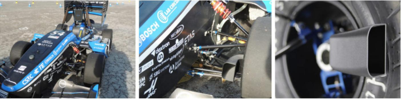
Por supuesto, el funcionamiento de los frenos es esencial para el manejo del automóvil. Un sobrecalentamiento excesivo podría deformar el disco, provocando vibraciones e incluso un fallo total del sistema de frenado. Por eso, para garantizar que la temperatura no aumente y no afecte su funcionalidad, es esencial incorporar conductos de refrigeración para los frenos.
